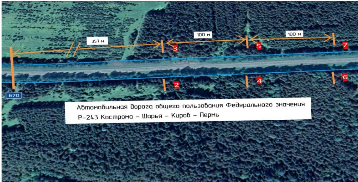
Расстояние от бровки земельного полотна до края рекламной конструкции 10 метров
