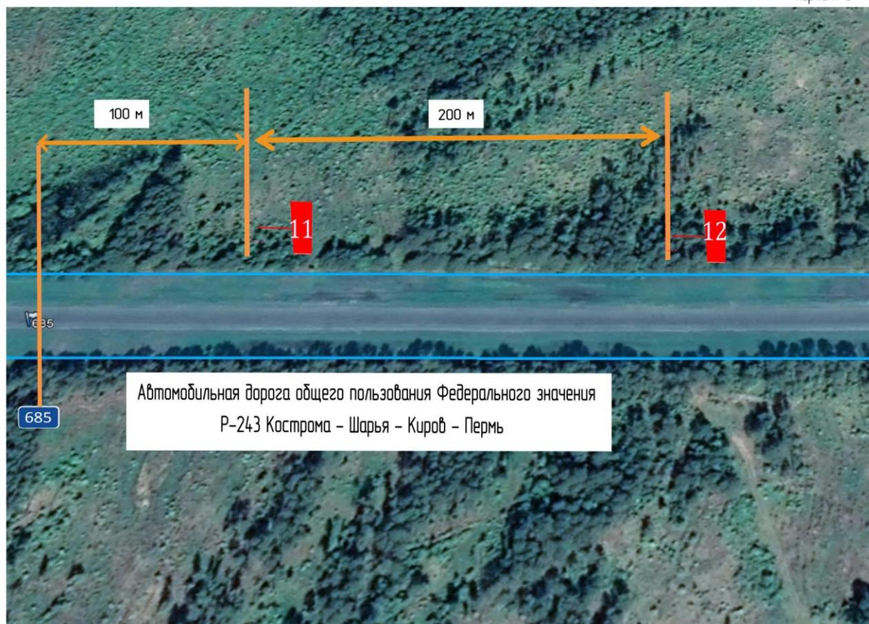
Расстояние от бровки земляного полотна до края рекламной конструкции 10 метров
