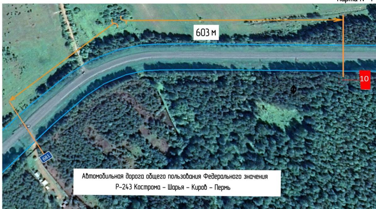
Расстояние от бровки земляного полотна до края рекламной конструкции 10 метров
