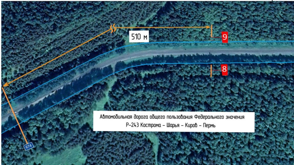
Расстояние от бровки земельного полотна до края рекламной конструкции 10 метров
